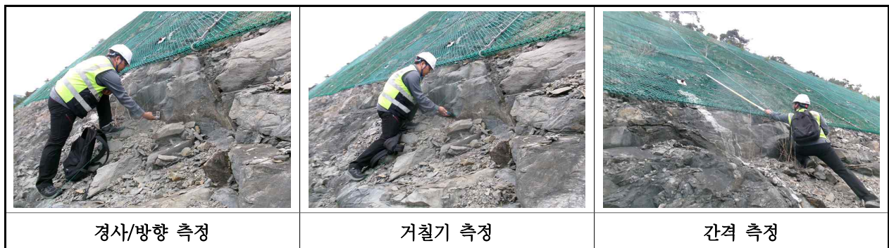
【사진 47.3.3】 불연속면 측정 현황
